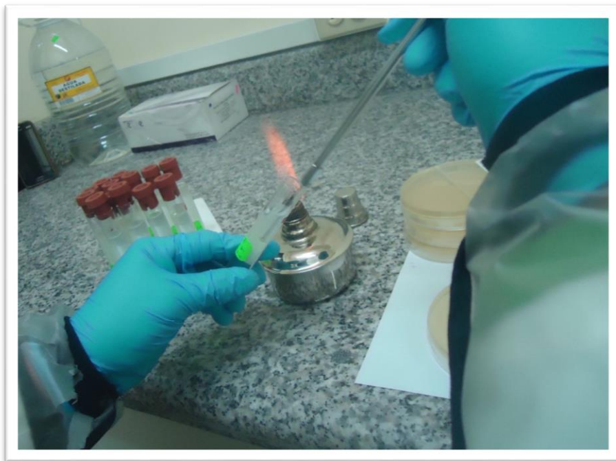
Fig. 10 Título: Introducción del asa en el interior del tubo de ensayo con la muestra de agua.
