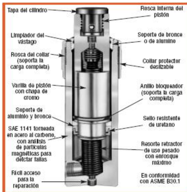
Fig. 3.1 Cilindro de simple efecto
