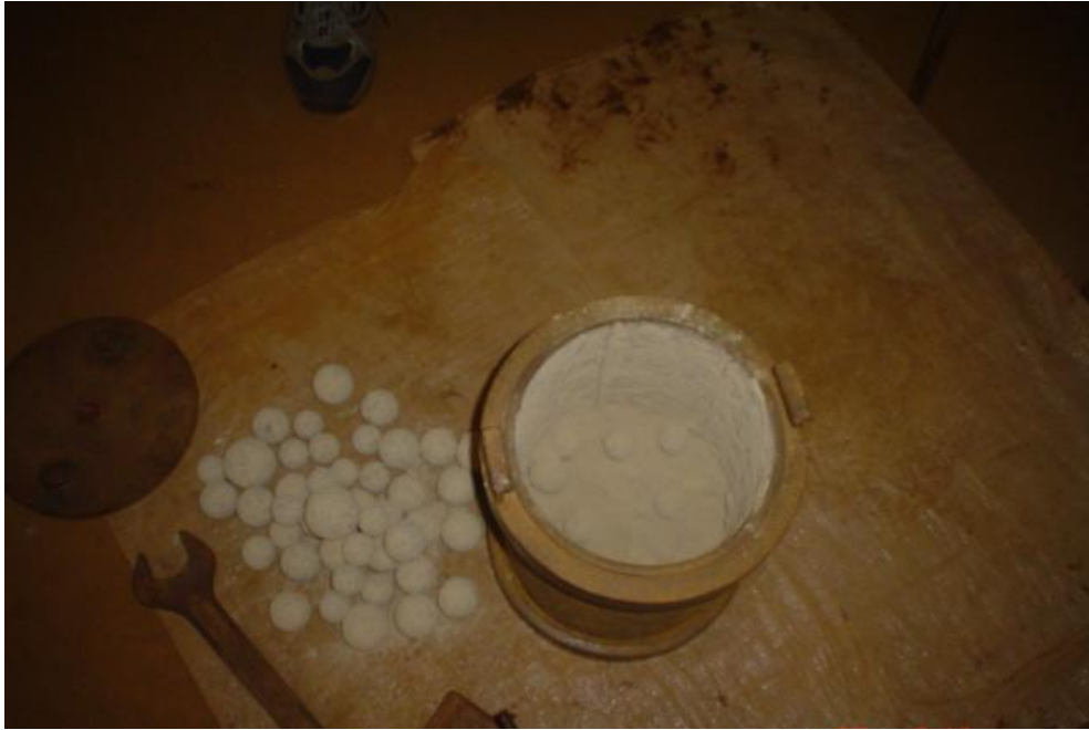
Molino de bola para la automatización de la zeolita de mayor a menor granulometría
