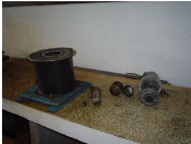
Partes de ensamblado de la instalación piloto de reprocesado de aceite colector, filtros
