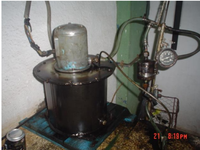
Instalación piloto de reprocesado de aceite en funcionamiento
