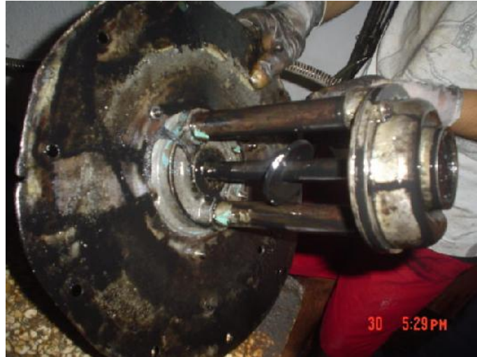
Bomba de paleta después de las corridas de aceite usado
