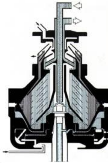
Fig.2.2 Sección transversal de una separadora centrífuga.
