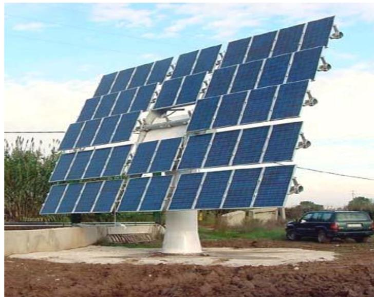
**Figura 2.18- Seguidor monoposte con accionamiento hidráulico**
