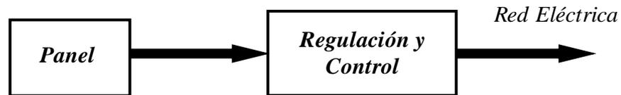
**CONECTADA A LA RED****Figura 2. 4- Sistema fotovoltaico conectado a la red eléctrica**
