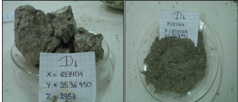
Fotografía 29. Muestras de suelo tomadas en el escarpe del Deslizamiento 1
