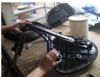
8. Colocar la platina en la tapa del espaldar.
