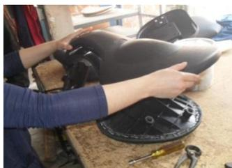
9. Colocar la tapa del espaldar a la base a presión y asegurar.
