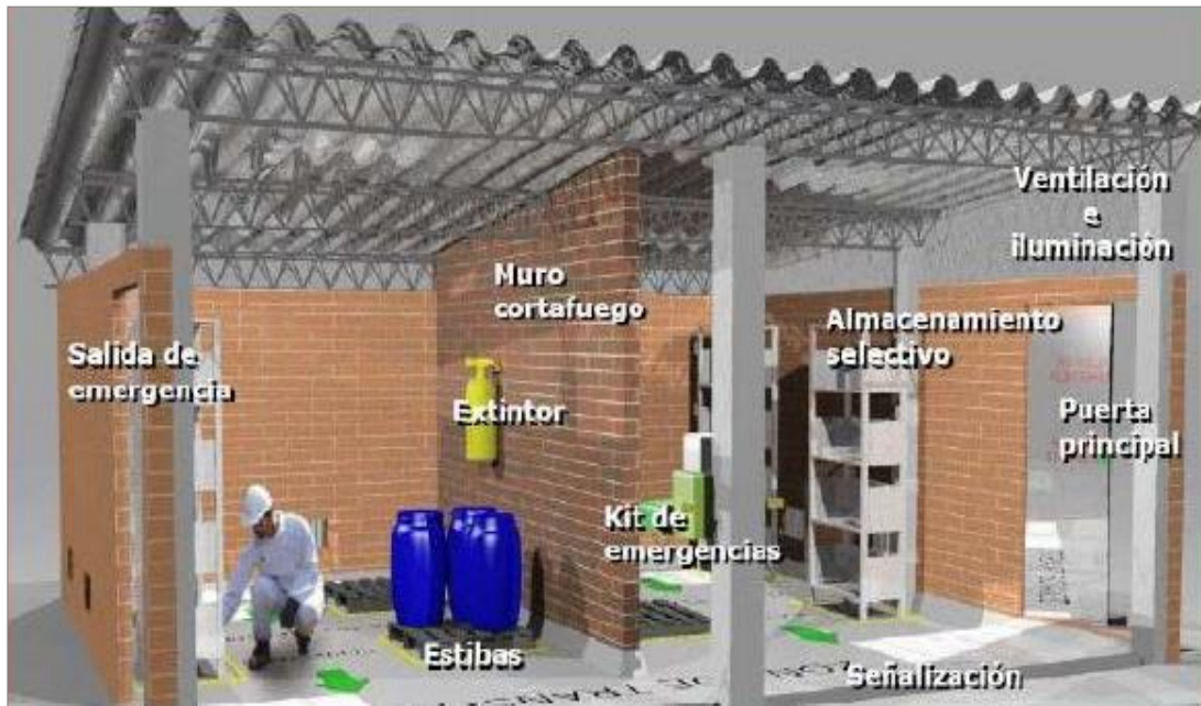
Foto 1. Envases adecuados para el almacenamiento de desechos líquidos peligrosos forma correcta de acumularlos
