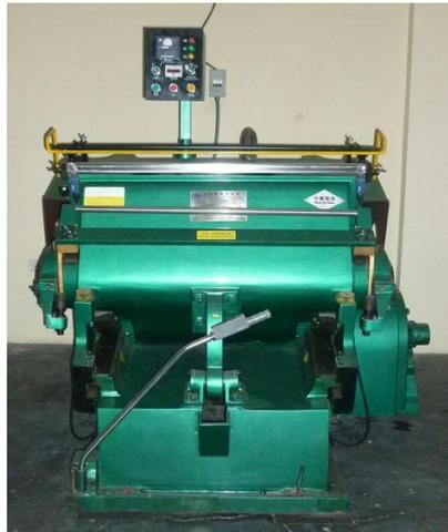
La maquina troqueladora es la que sirve para el diseño y corte de los moldes de las plantillas sean estas en cuero, suela o sueleta.
