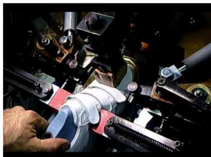
Es muy útil para el armado de las partes del zapato, la misma que permite la uniformidad de las piezas.
