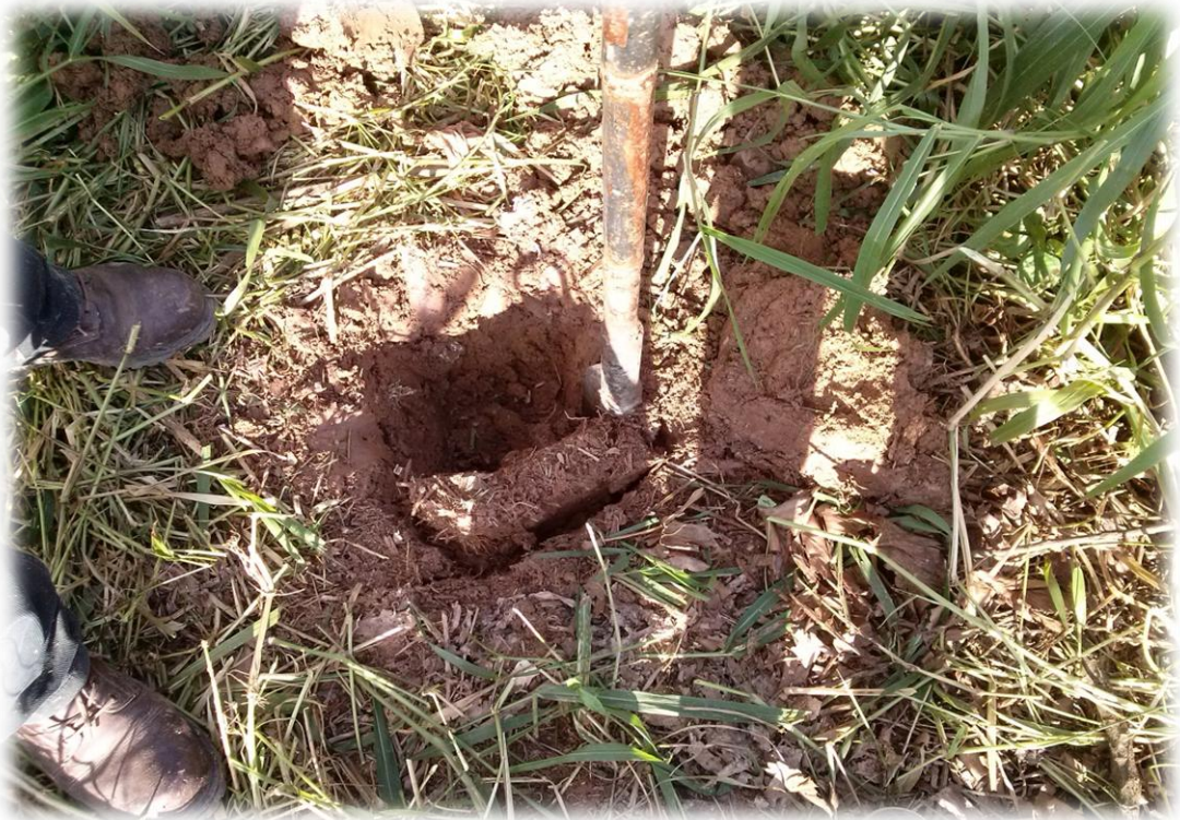
Perforación en V para obtener muestra de suelo.
