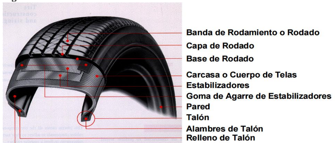
Figura 3. Partes de las Llantas.
