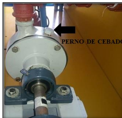
FIG 44. Proceso de cavado de la bomba Fuente: El autor
