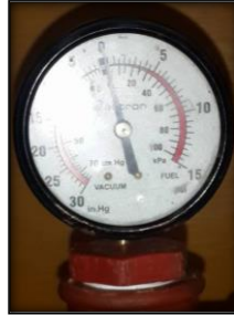
FIG 50. Vacuómetro para medir presiones a la entrada de la bomba Fuente: El Autor
