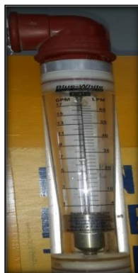
FIG 52. Caudalímetro (GPM, LPM) Fuente: El Autor
