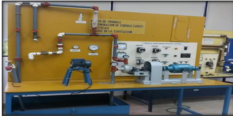
FIG 26. Banco de pruebas hidráulicas construido para el análisis de rodetes semiabiertos tipo radial Fuente: El Autor
