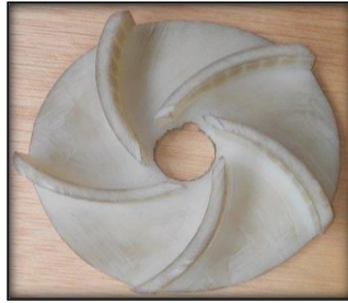
FIG 32. Rodete 3 construido Fuente: El autor
