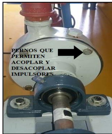
FIG 43. Acoplamiento del Rodete en la carcasa de la bomba Fuente: El autor
