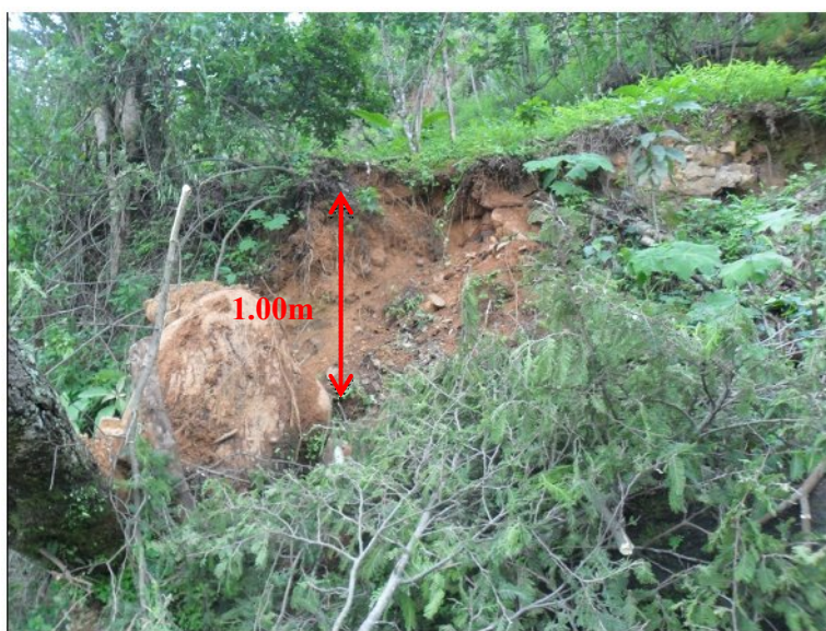
Fotografía 17. Pequeño deslizamiento presentando coluvial de aproximadamente 1 m y cubierto por una capa de suelo de aproximadamente 20 cm de espesor.
