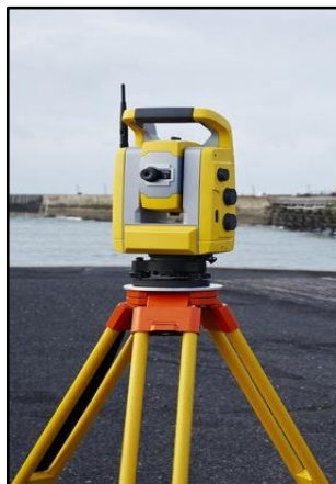
Fig.7.2. Estación robótica S3 TRIMBLE.
