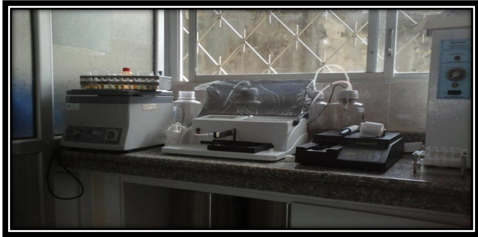
Equipos para el lavado de muestras y analizador microelisa de las mismas
