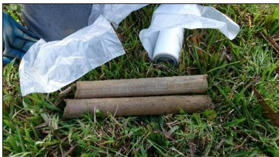
**Figura 44.** Testigo SPT de 0 – 1m.
