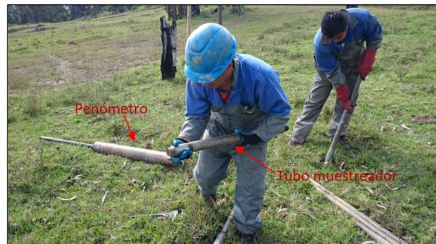
**Figura 18.** Penetrómetro y tubo muestreador del SPT
