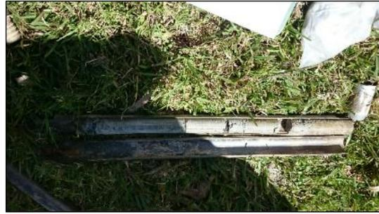
**Figura 47.** Testigo SPT de 3 – 4m.
