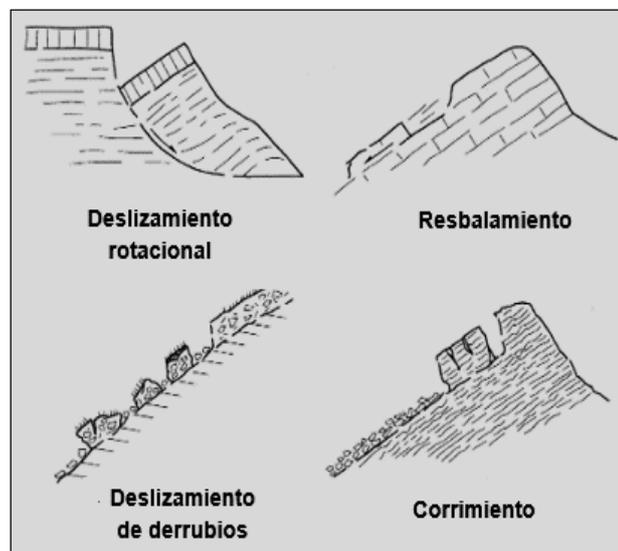
**Figura 5.** Tipos de deslizamiento
