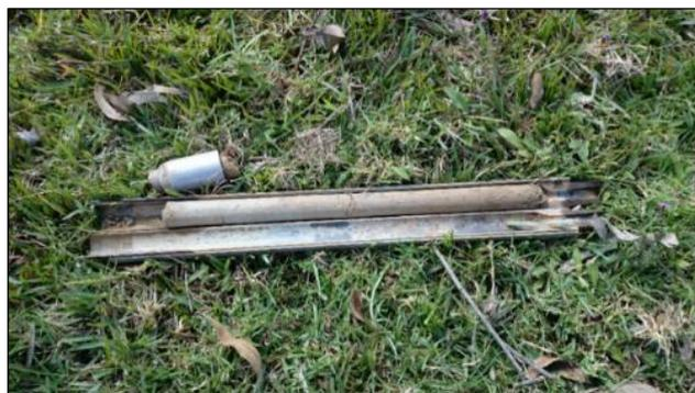
**Figura 19.** Muestreador del SPT.
