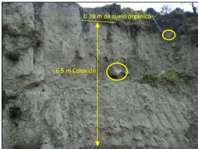
**Figura 36.** Afloramiento de coluvión grueso en la vía
