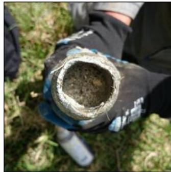
**Figura 48.** Testigo SPT de 4 – 5m.
