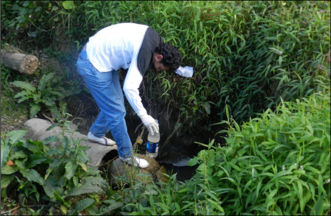
Fotografía 3. Muestreo de Agua en Descarga.
