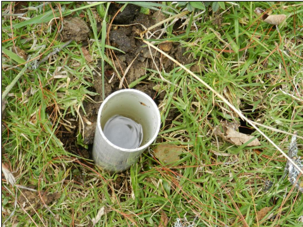
Fotografía 9. Ensayo de Permeabilidad INSITU.
