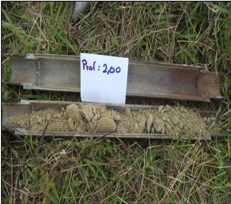
Figura 66. Testigo SPT de 1-2m. Fuente: Elaboración propia
