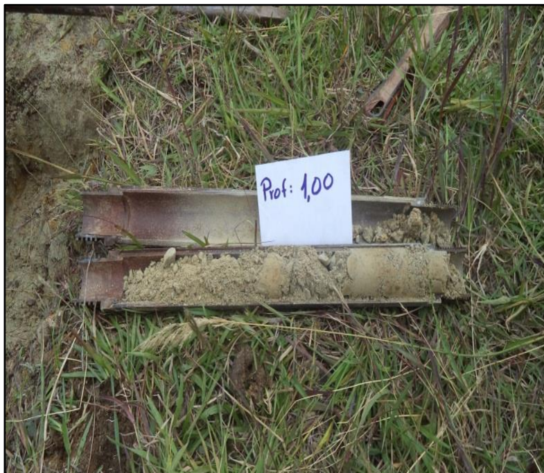
Figura 65. Testigo SPT de 0-1m.
