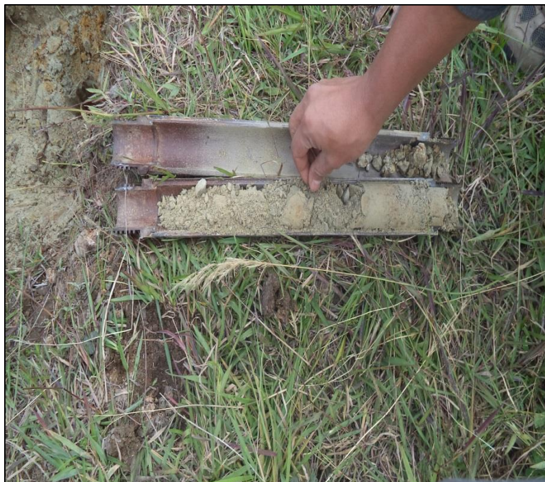
Figura 67. Testigo SPT de 2-3m. Fuente: Elaboración propia
