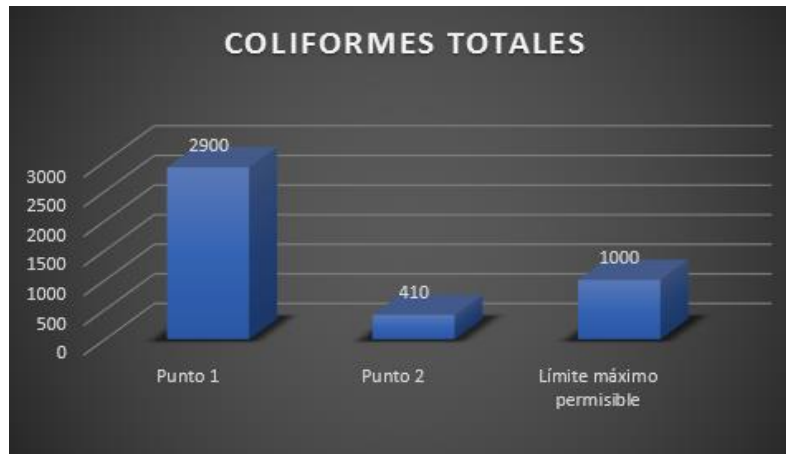
Figura 30. Comparación de resultados del parámetro de Coliformes Totales (muestra 2) Fuente: El autor
