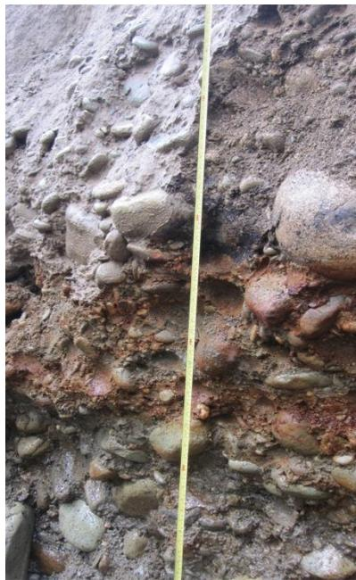
**Figura 22:** Diferenciación de capas y medida de las potencias.
