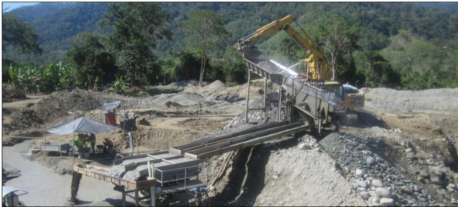
**Figura 58.** Lavado de gravas y concentración gravimétrica.
