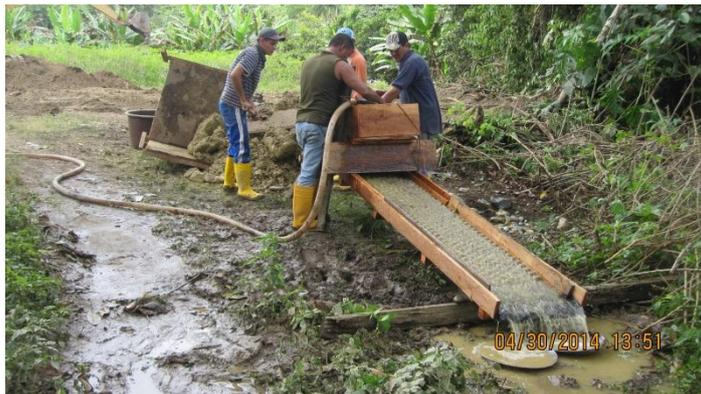
**Figura 25:** Lavado de muestras para obtener el concentrado
