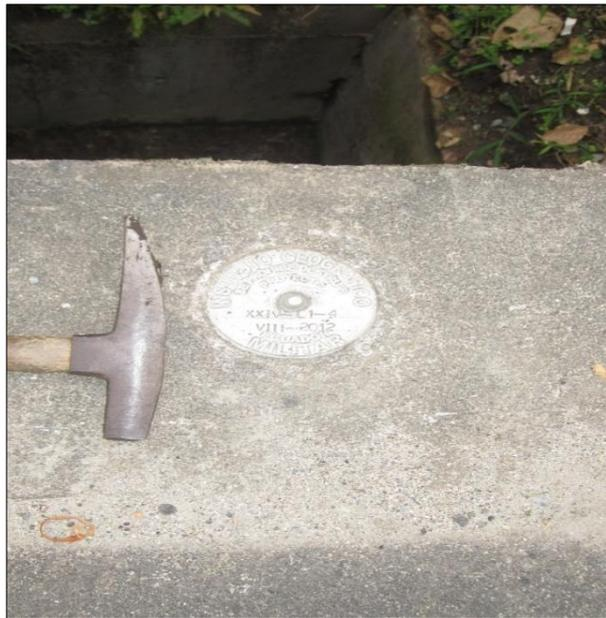
**Figura 9.** Punto de partida para el levantamiento del IGM.
