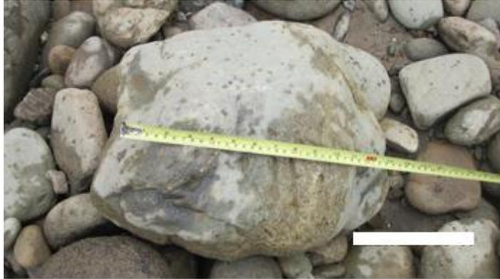
**Figura 26:** Medida de boulders contenidos en la muestra de un cúbico
