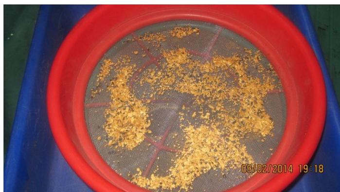
**Figura 32:** Tamices para separación del Au y la magnetita fina.
