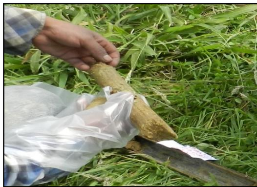
Figura 11.- Material Arcillo limoso resultados del SPT a los 2 m.
