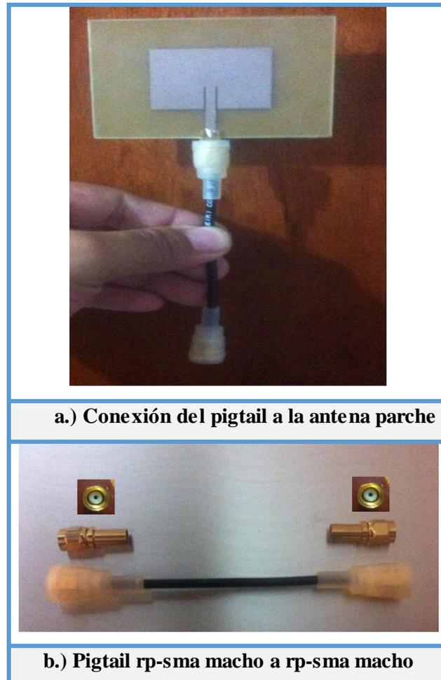
**Figura 105. Conexión de la antena al extremo del Pigtail.**
