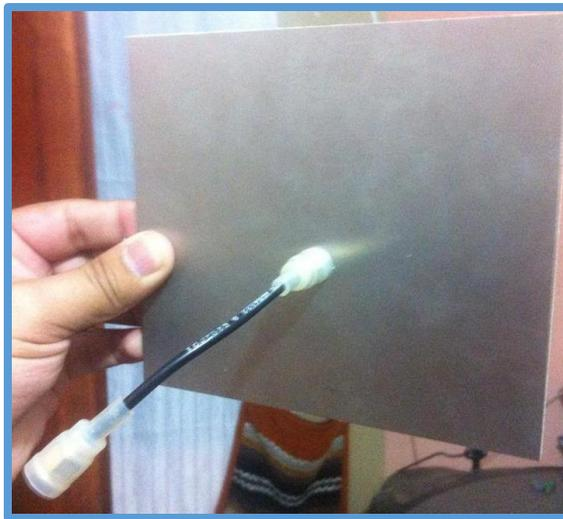
**Figura 107. Conexión del pigtail al conector rp-sma de la antena 2x2.**
