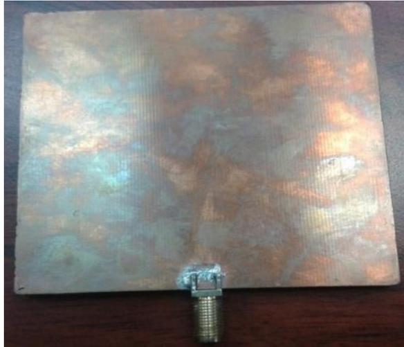
**b.) Soldadura posterior conector rp-sma hembra**
