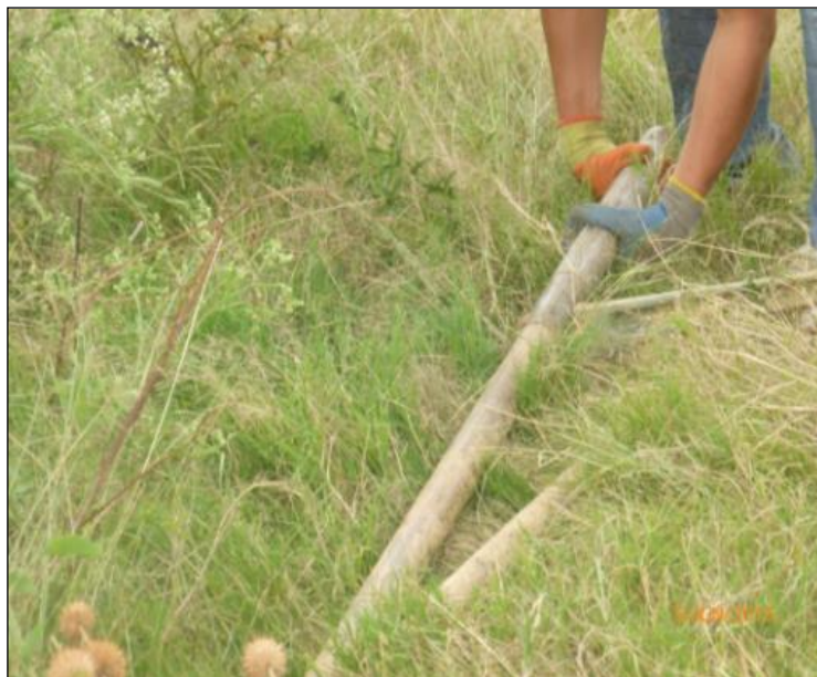
Foto 6. Tubo muestreador del SPT Fuente: El Autor
