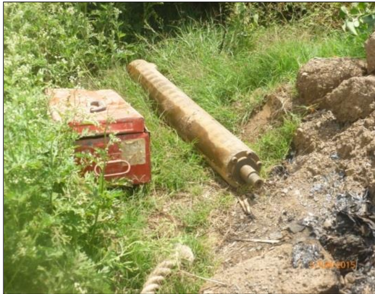
Foto 5. Penetrómetro del SPT Fuente: El Autor
