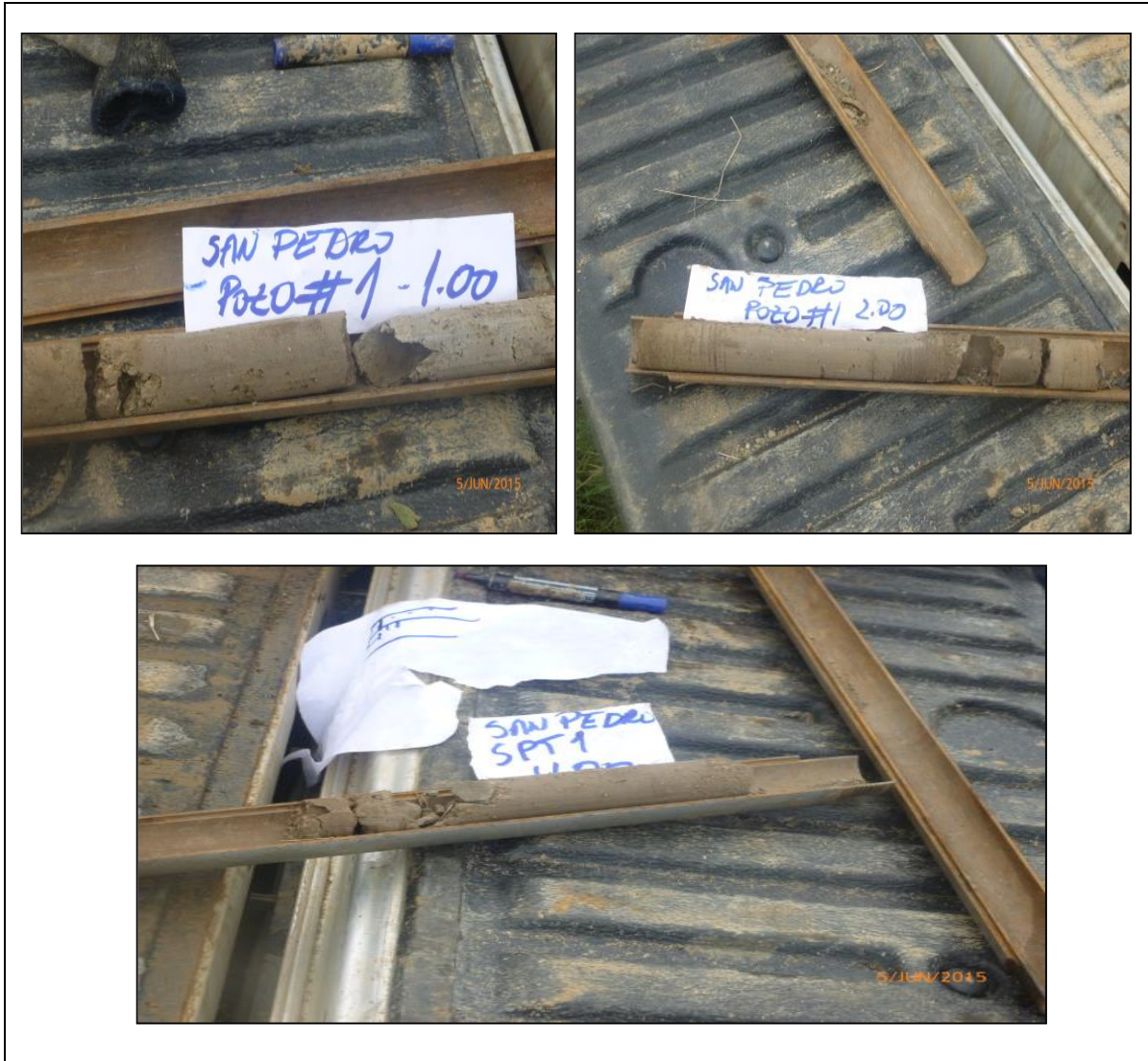
Foto 22. Testigos de perforación de la zona de estudio, SPT1
