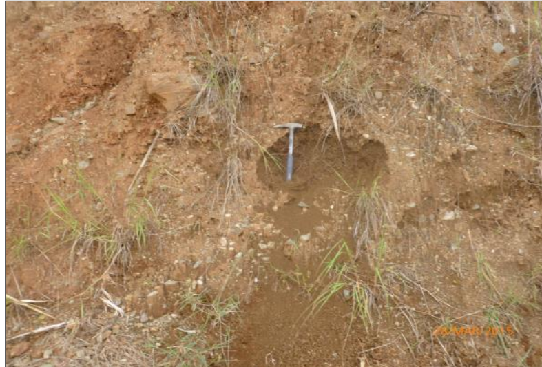
Foto 13. Arcillas compactas de color café oscuro con intercaladas de areniscas, sector vía al Cisne, M5 Fuente: El Autor
