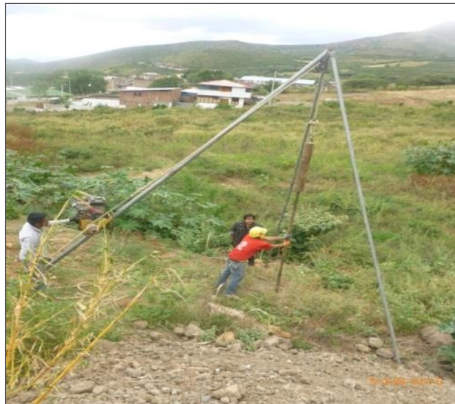
Foto 4. Proceso de hincamiento SPT
