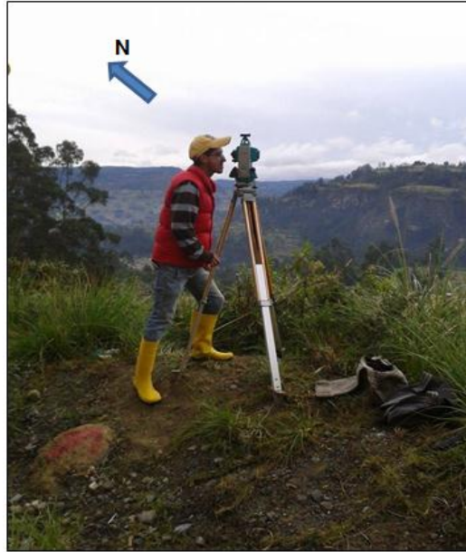
Figura 25. Levantamiento Topográfico con estación SOKKIA Serie 610 desde el sector Oeste de la comunidad Las Lagunas.
