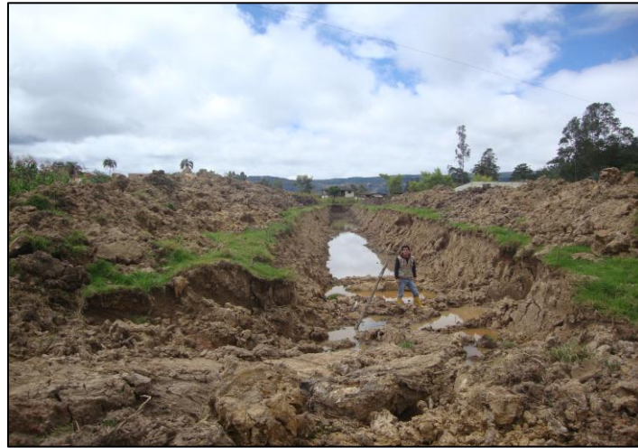
Figura 47. Zanja N° 2 de material limoso en el flanco Este de la comunidad Las Lagunas.
