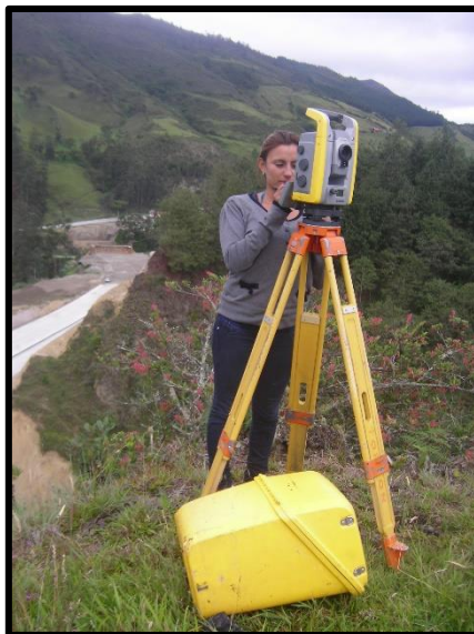
Figura 5. Levantamiento topográfico mediante la estación Total Trimble S6.
