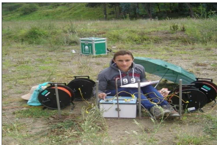
Figura 7. Medición de lecturas de resistividad eléctrica mediante Syscal Junior/R1 Plus. Fuente: La Autora.
