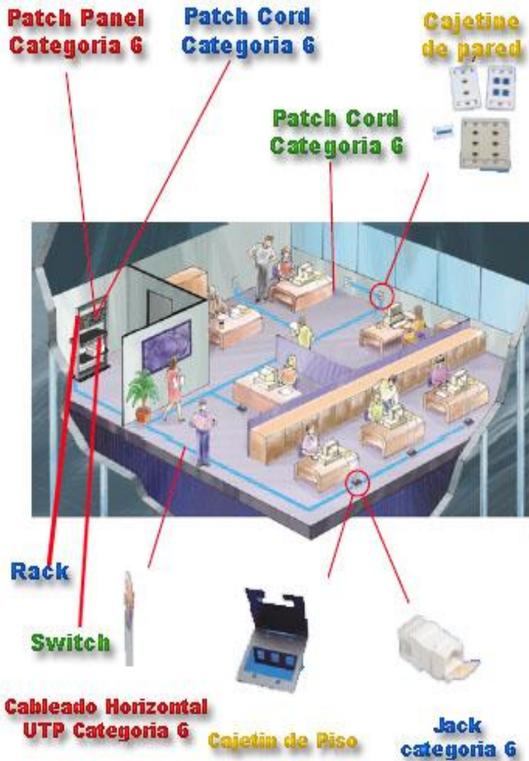
Grafico 18. Descripción de los componentes del cableado Horizontal.
