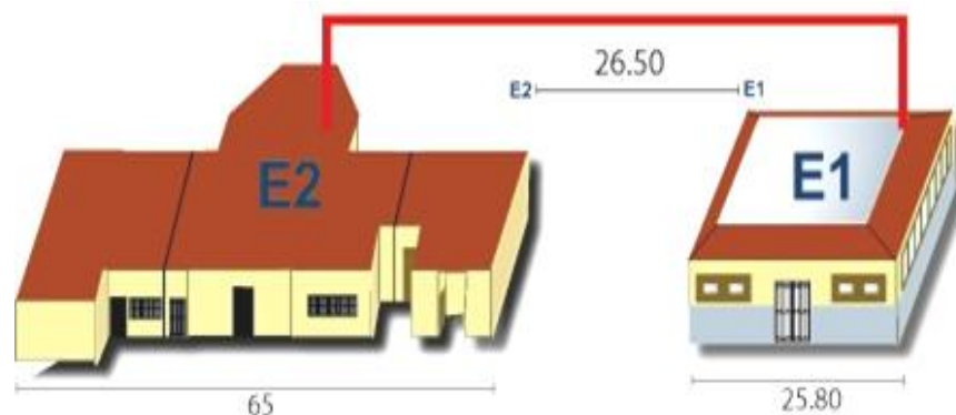
Figura 3.4. Conexión entre el Edificio Uno y el Edificio Dos
