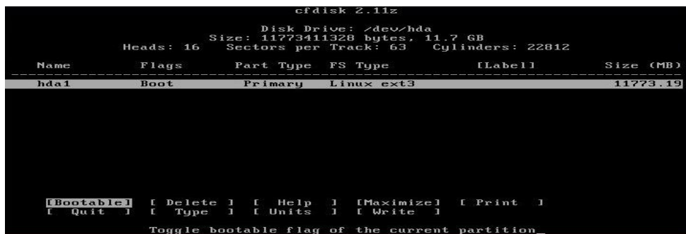
Figura 19: Seleccionar partición como booteable
