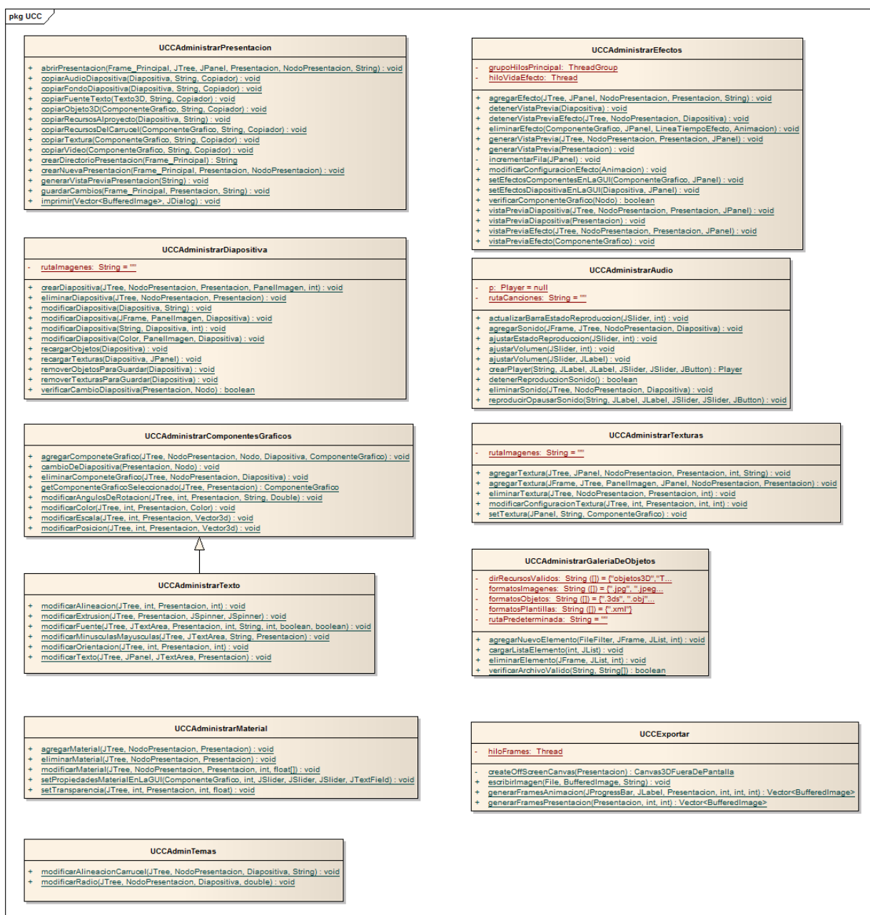
Figura 117 Diagrama de Clases del Paquete UCC
