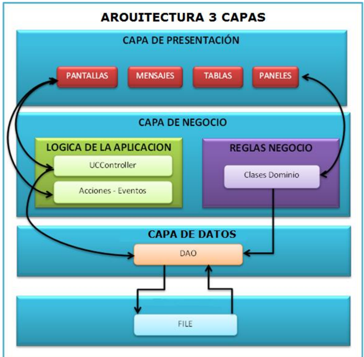
Figura 115 Arquitectura del Sistema
