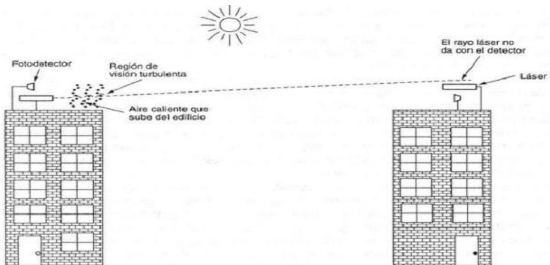
Figura 1.10. Transmisión por Ondas de Luz
