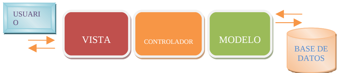
Figura 7.1: Imagen de la Arquitectura tres capas
