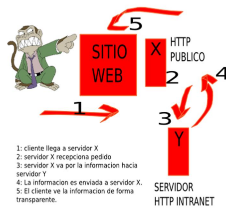
Fig.2: Funcionamiento del mod_proxy Reverse Proxy
