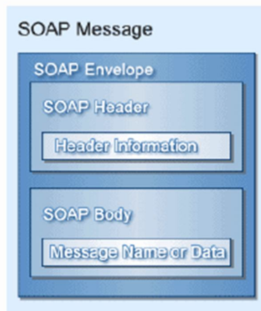
Fig.6: Estructura de Mensaje SOAP
