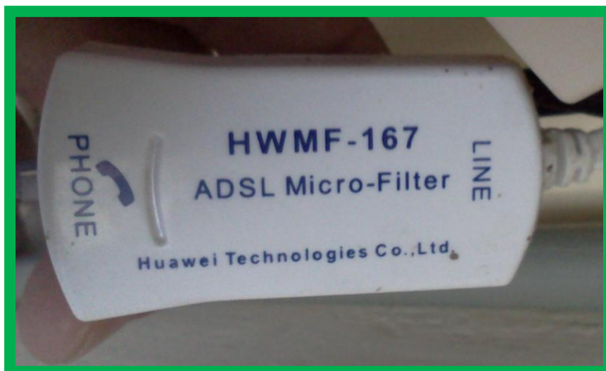
Filtro ADSL para eliminar interferencias.
