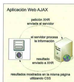
Figura 2.1. Funcionamiento de AJAX
