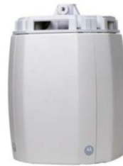
Figura 13. Punto de acceso mesh Motorola 7181
