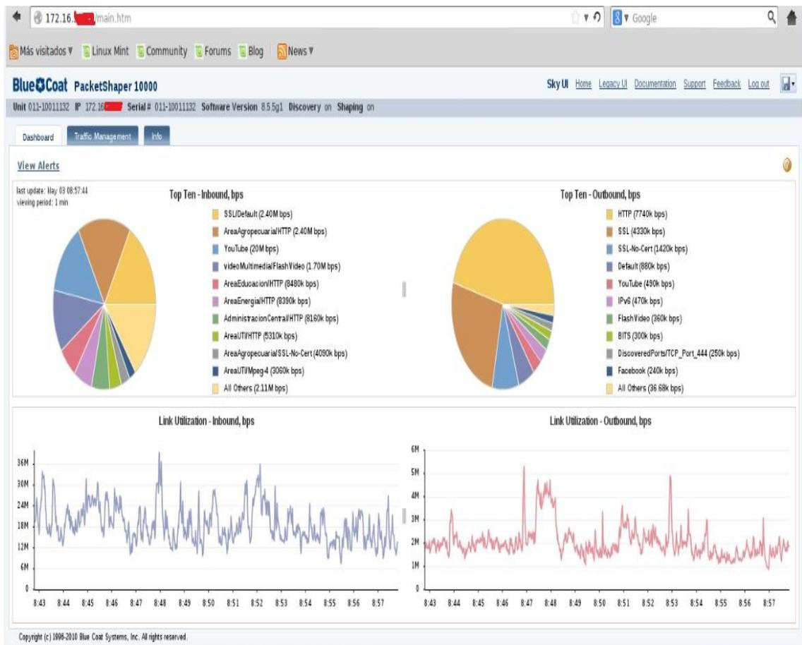
**Figura 42 Consumo de ancho de banda utilizando el segmentador de ancho de Banda Bluecot**
