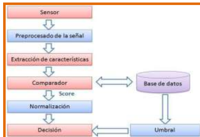
Figura 1. Arquitectura general de un sistema biométrico.
