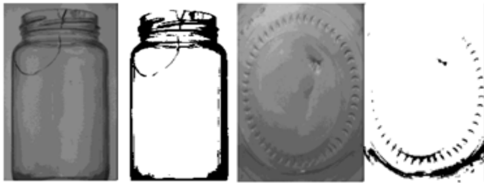
Figura 8. (a) Inspección Lateral, (b) Inspección de Fondo.
