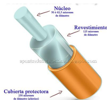
Figura 9 Fibra Multimodo (MM)
