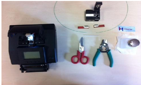
Figura 19 Equipos de empalme
