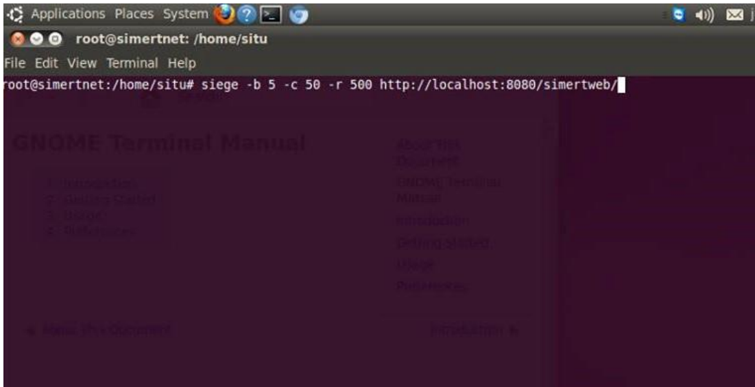
Figura 40: Comando de ejecución de Carga con Siege.
