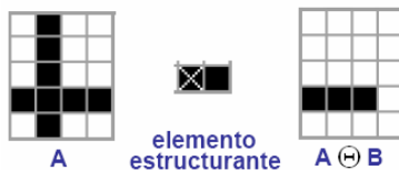
Figura 39: Erosión con un elemento estructurante de 1x2
