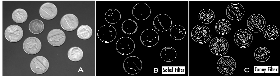
Figura 34: A) Imagen Original, B) Filtro Sobel, C) Filtro Canny.
