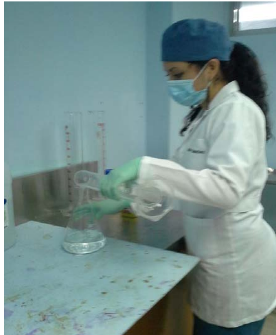
Fig 3. Colocar el agua destilada en un matraz
