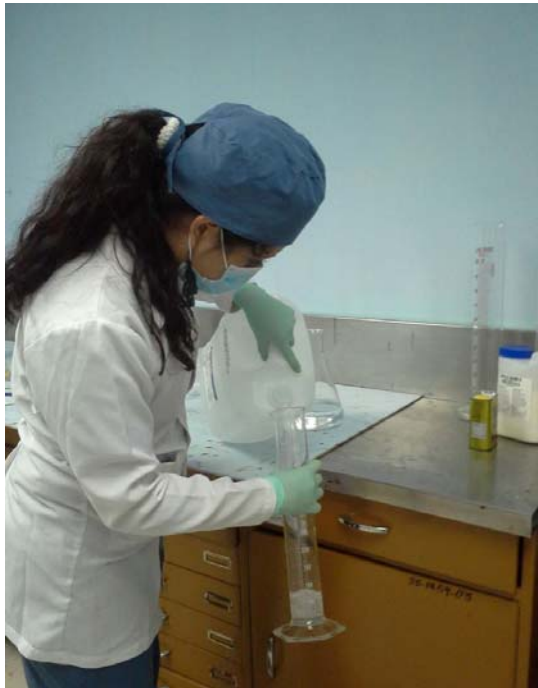
Fig 2. Medir 1000 ml de agua destilada
