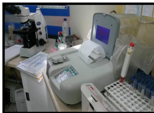
**Fig. 7.** Espectrofotómetro para determinación de Sodio
