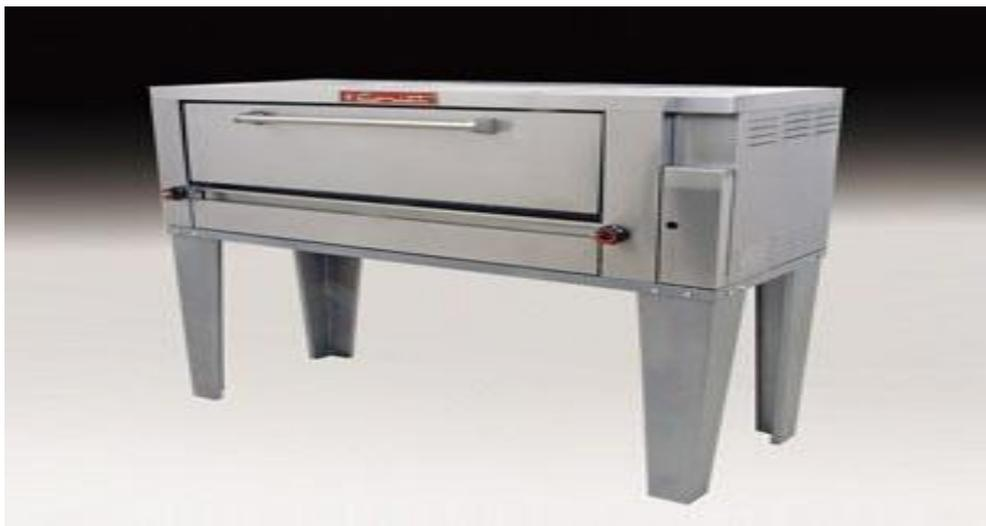
**CARACTERISTICAS:** Capacidad para 100 pizzas de dos porciones por hora. Termostato de 100 a 350 grados centígrados. Válvula pilostática de seguridad. Pisos refractarios. 2 aletas para graduación del calor. Frente en acero inoxidable. Peso: 320 kg. Funciona totalmente a gas. La presión requerida para el óptimo funcionamiento es de 28 cm (11") columna de agua con regulador de baja presión. Recomendamos un tubo de
