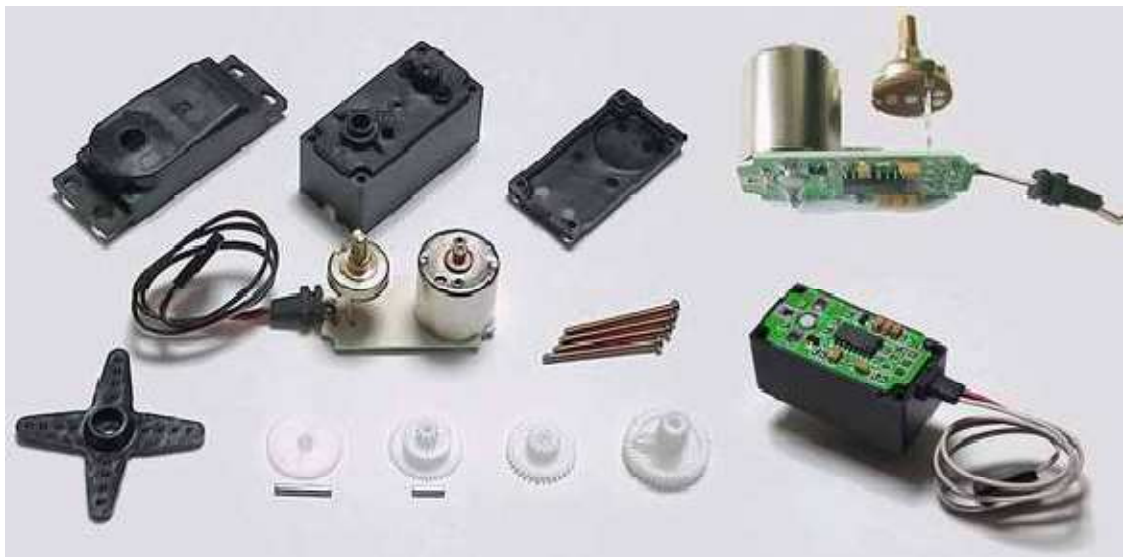
Fig. 3.35 Componentes de un servo: a) carcasa; b) motor DC; c) potenciómetro; d) circuito de control; e) tren reductor; f) brazo (elemento terminal en el eje)
