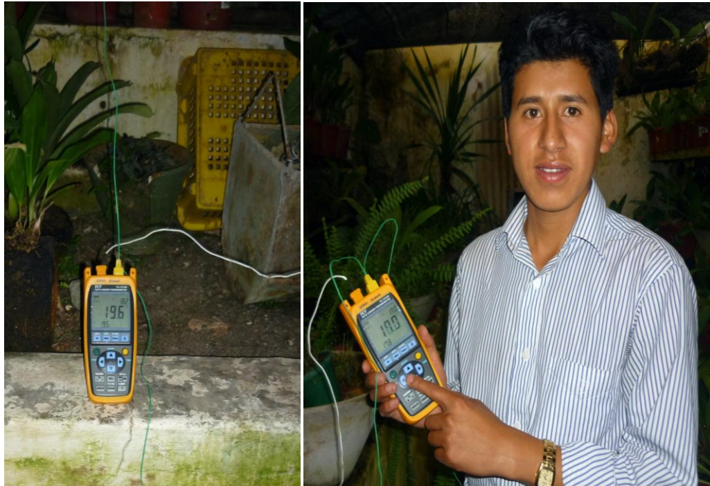
Medición de la temperatura interna con el datalogger de temperatura
