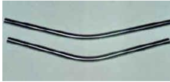
Fig. 1.5. Probetas SAE 1015 y 1045 al suspender el ensayo
