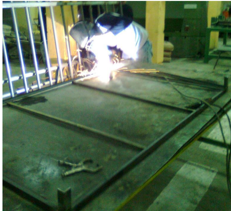
Fig.31. Soldado de la caja del colector
