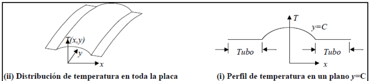
Fig.7: Distribución de temperatura en la placa de absorción
