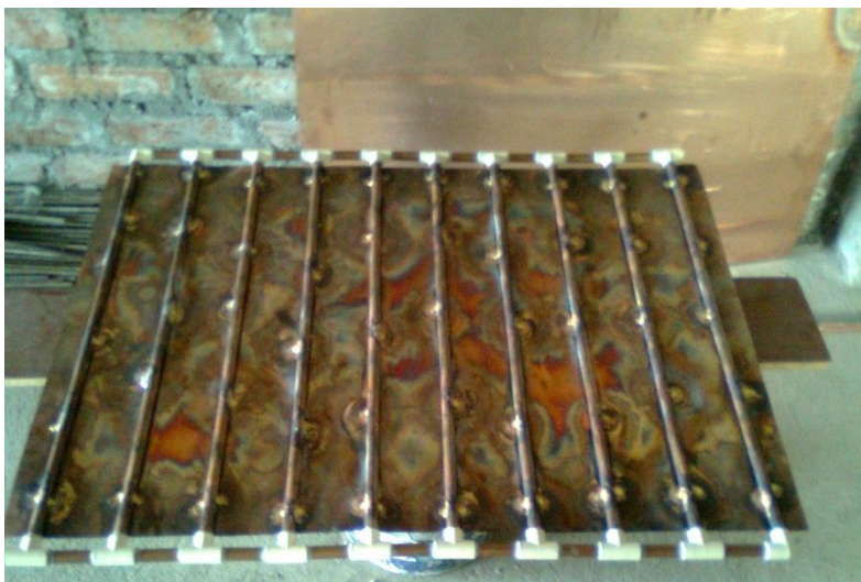
Fig. 33. Plancha colectora de cobre con su tubería acanalada y soldada
