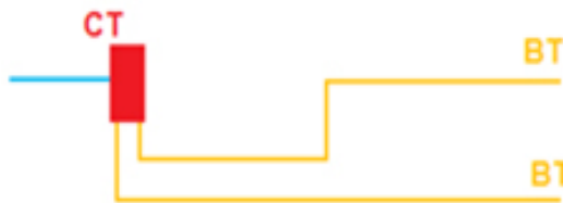
Figura 8. Sistema de distribución eléctrico radial.
