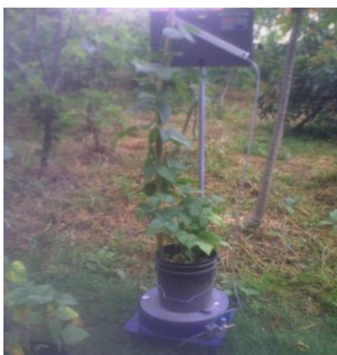
Figura 8. Demostración del registro de lecturas en el lisímetro.
