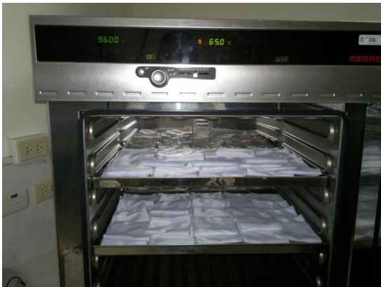
Foto 3: Esterilización de bolsa de nylon en estufa
